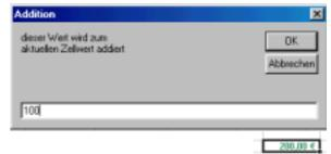
Zur Sicherheit wurde eine Fehlerroutine eingefügt, um die Eingabe von Buchstaben abzufangen. Sollte ein solcher Fehler eingetreten sein, so wird eine MsgBox angezeigt, in der Sie gefragt werden, ob Sie die Eingabe wiederholen möchten.
